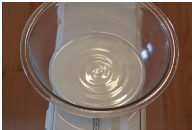
ILUSTRACJA 16.25 Fale stojące zostały utworzone na powierzchni mleka w misce, umieszczonej na obudowie wiatraka. Drgania wiatraka powodują, że powierzchnia mleka drga.
