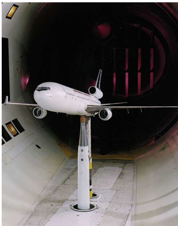
ILUSTRACJA 6.30 Naukowcy NASA testują modele samolotów w tunelach aerodynamicznych. (Źródło: NASA/Ames)
