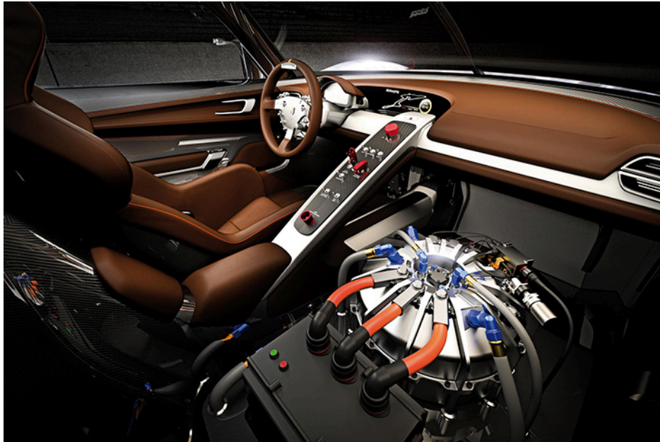
ILUSTRACJA 10.18 Na fotelu pasażera umieszczono urządzenie wykorzystujące koło zamachowe do odzyskiwania energii kinetycznej w samochodzie. (Źródło: „cmonville”/Flicker)
