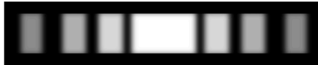
ILUSTRACJA 4.9 (a) Obliczony rozkład natężenia światła w dyfrakcji na pojedynczej szczelinie. (b) Rzeczywisty obraz dyfrakcyjny.
