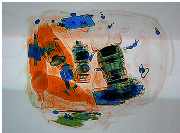
ILUSTRACJA 8.26 Obraz rentgenowski bagażu. Im gęstszy materiał, tym ciemniejszy cień. Kolory przedmiotów odnoszą się do składu materiałów np. obiekty metalowe wyświetlane są jako niebieskie. Źródło: „IDuke”/Wikimedia Commons
