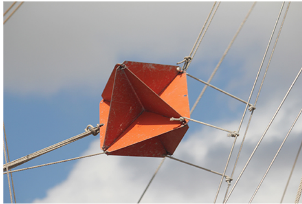
ILUSTRACJA 1.11 Reflektor radarowy podwieszony na olinowaniu jachtu jest rodzajem zwierciadła narożnego. Źródło: Tim Sheerman-Chase
